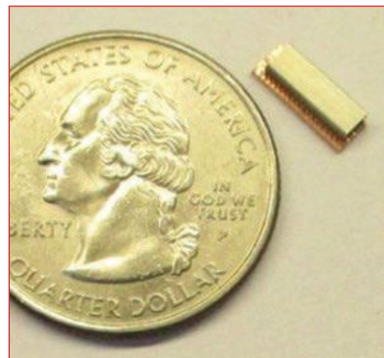
▲ Fig. 3 mmW-FH SIW filter.
